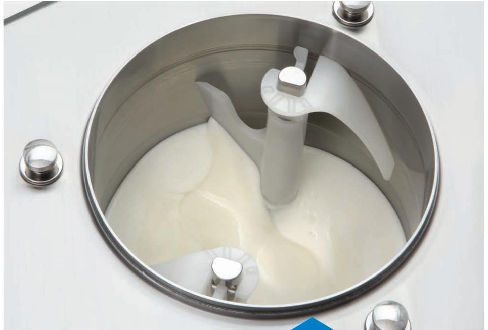
La **velocità dell'agitatore** può essere modificata in base al tipo ricetta per esaltarne la texture e la struttura finale.
