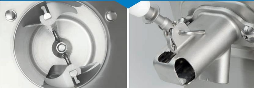
**Il rubinetto e l'agitatore sono smontabili,** per facilitare la completa rimozione di ogni residuo di prodotto, per una pulizia integrale.
