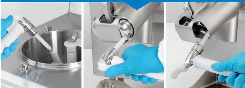
**Grazie alla funzione del lavaggio a caldo,** il cilindro può essere riscaldato in modo da sciogliere e staccare rapidamente i residui grassi di produzione.
