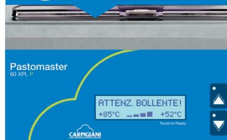
**Coperchio e Display:** Superati i 50 °C, per evitare spruzzi di miscela bollente, alzando il coperchio l'agitazione si ferma. Il display, attraverso un messaggio, avvisa l'operatore che all'interno della macchina ci sono prodotti caldi per evitare manovre errate.
