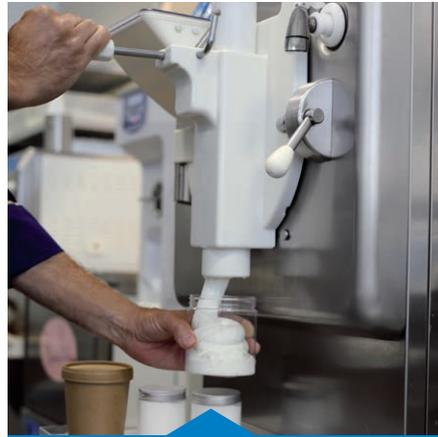
**Portello Porzionatore Crystal**. Ideale con l'utilizzo del programma Crystal per il riempimento di contenitori e vasetti direttamente dalla macchina.
