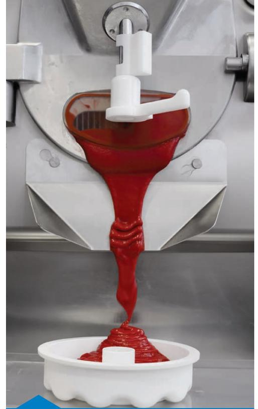
Grazie al **distanziale**, che può essere montato in qualsiasi momento, è possibile ridurre l'apertura dello sportellino di uscita facilitando così l'estrazione del prodotto Crystal e il lavaggio macchina.
